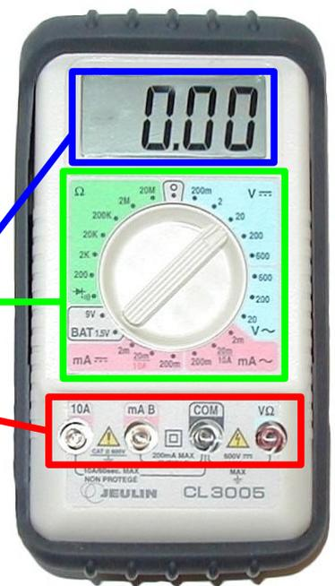
Pour une **première mesure** on choisit toujours le plus grand calibre de la grandeur à mesurer avant de placer le multimètre dans le circuit afin de protéger l'appareil. Une fois la valeur connue, on choisit le calibre supérieur à la mesure afin d'améliorer sa précision.
